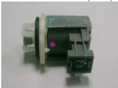
Electrovanne régénération 6W - 4130 ±10ohm (25C°)
