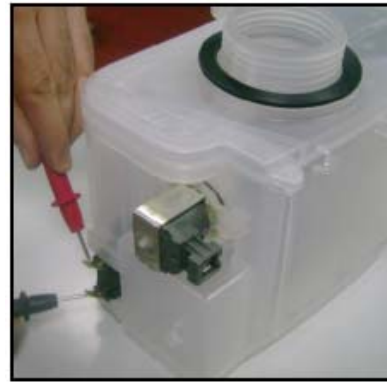
0 Ω (sans sel) et ∞ Ω (avec sel)
