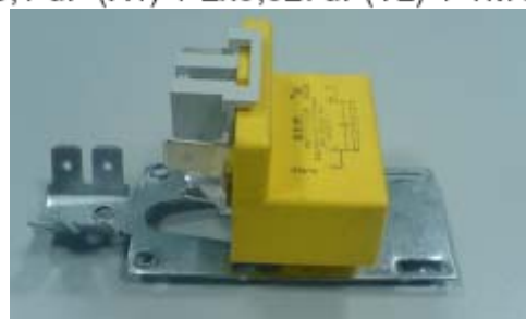
Condensateur Anti-parasite 0,1 uF (X1) + 2x0,027uF(Y2) + 1M Ω
