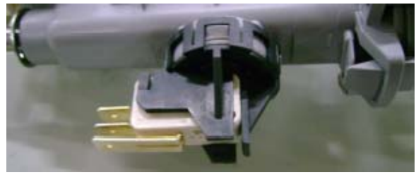
Distributeur Position 1 : Bras supérieur Position 2 : Bras inférieur
